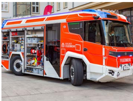
Das eLHF ist das erste elektrifizierte Löschfahrzeug in Deutschland. Es ist seit einigen Monaten im Testbetrieb.
