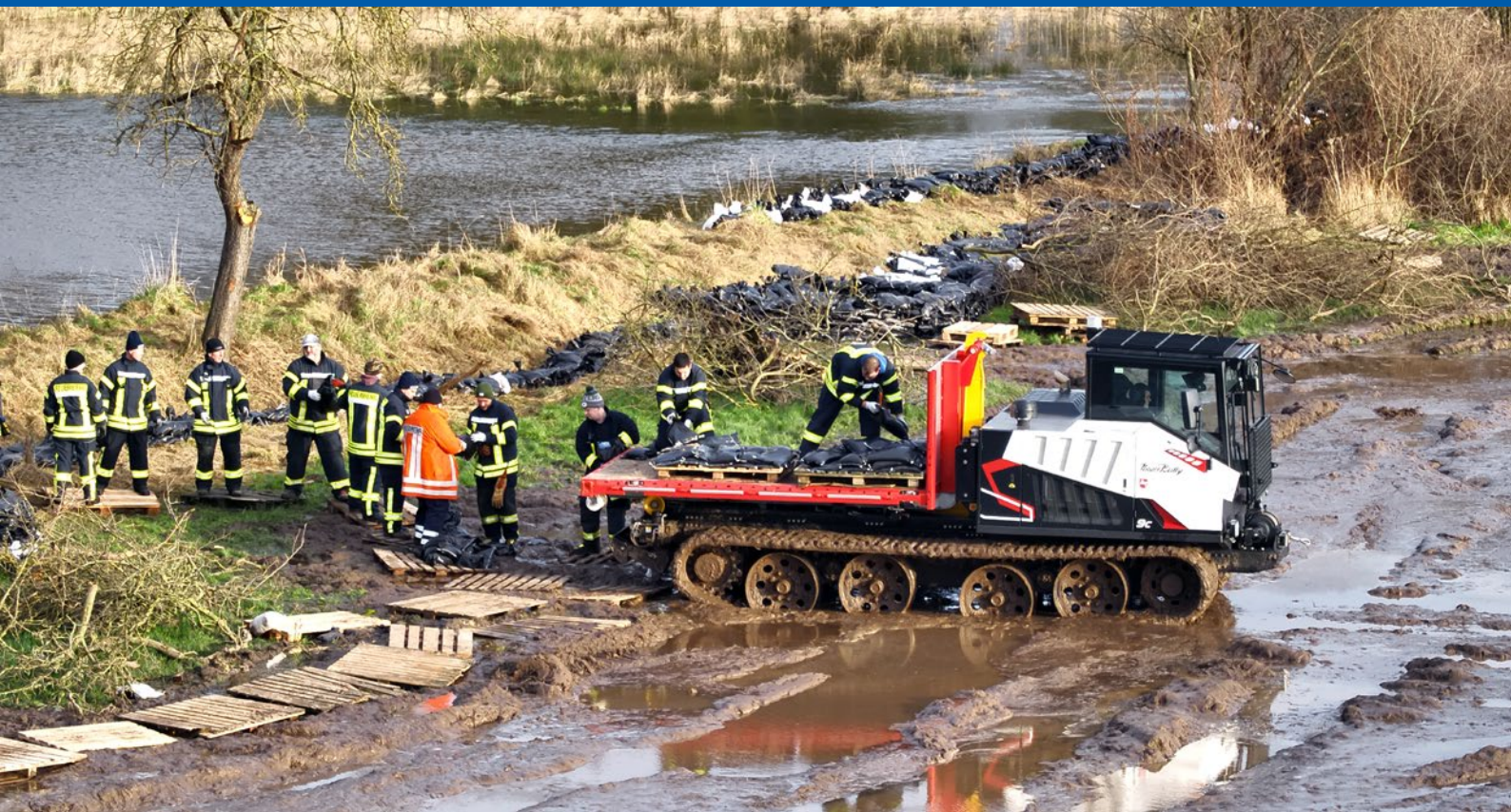
NLBK im Einsatz: Bei der Bereitstellung und der Bedienung von Spezialfahrzeugen entsendet das NLBK Material und Personal, wie hier das Erprobungsfahrzeug „Powerbully“ beim Sandsacktransport im Hochwassereinsatz.
