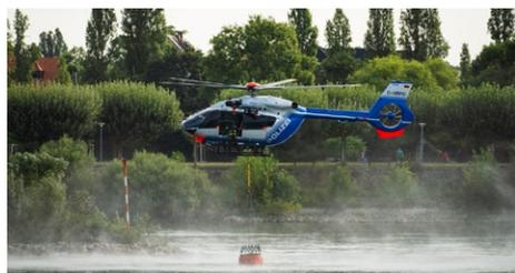
Dank zwei Turbinen mit je 900 PS Leistung beträgt die Fluggeschwindigkeit bis zu 280 km/h.
